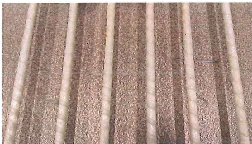
Внешний вид образцов после выдержки в щелочной среде
